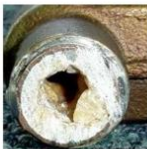
Gambar 5. Kerak magnesium karbonat pada pipa industri (Sihombing, 2025).
