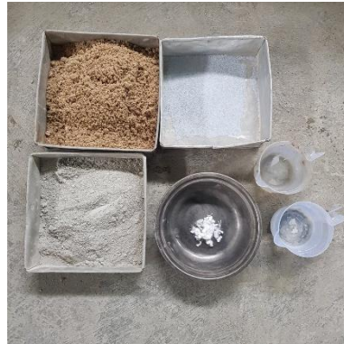
Gambar 3.19 Bahan campuran mortar.
