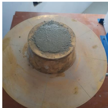
Gambar 3.24 Memasukkan mortar ke dalam flow mold .
