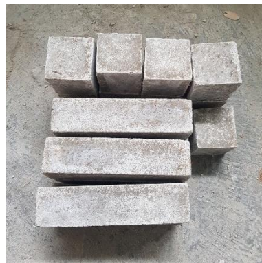
Gambar 3.30 Melepaskan benda uji.
