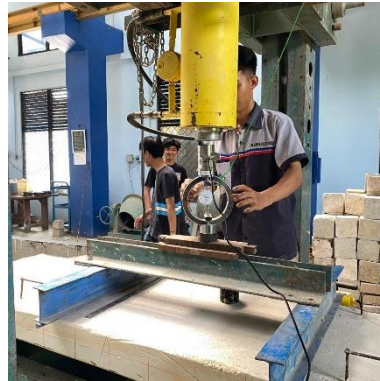
Gambar 3.38. Proses pemasangan pembebanan terpusat.
