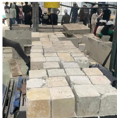
Gambar 3.38. Proses pemasangan pembebanan merata.
