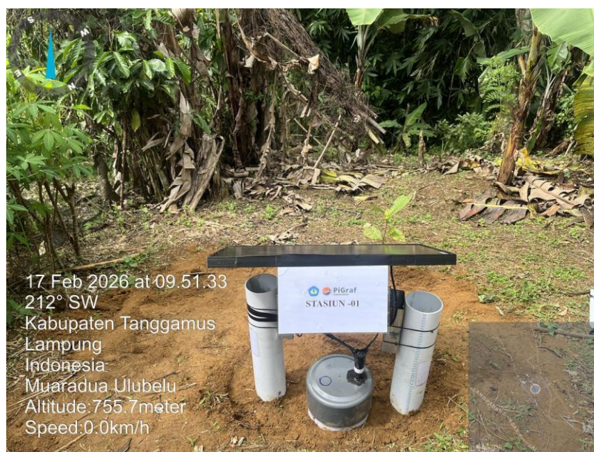
Gambar 17. Pemasangan stasiun PiGraf dengan panel surya
