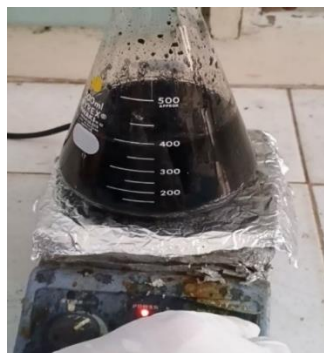
Gambar 3. 12 Pencampuran MWCNT dengan \text{HNO}_3
