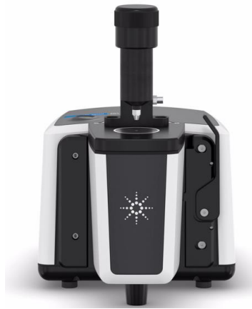
Gambar 3. 21 Bentuk dari alat FTIR Agilent Cary 630
