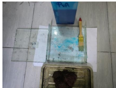
Gambar 3. 18 Penaburan OPEFB pada cetakan
