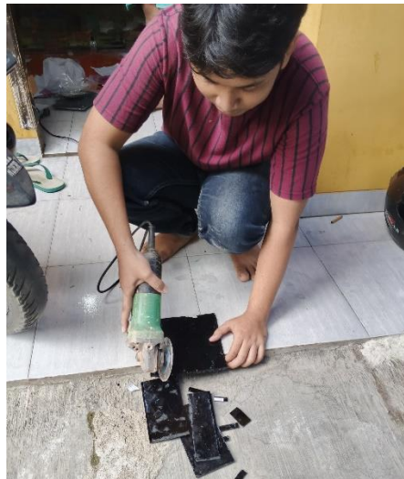
Gambar 3. 20 Pemotongan Material Komposit Sesuai Spesifikasi Pengujian
