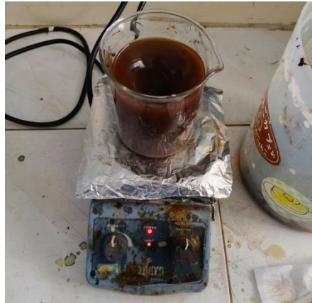
Gambar 3. 9 Melarutkan Anilin, HCl dan APS menggunakan HPMS
