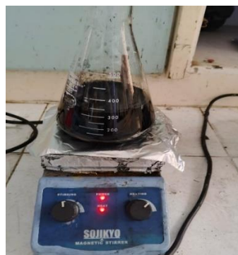
Gambar 3. 14 Pencampuran MWCNT dengan \text{H}_2\text{O}_2
