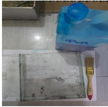
Gambar 3. 17 Pelapisan kaca dengan Polyvinyl Alcohol
