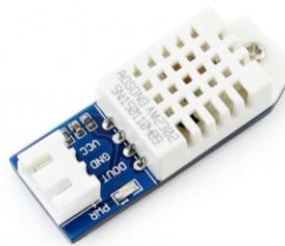
Gambar 4. Sensor Suhu dan Kelembaban Udara.
