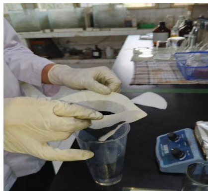
Gambar 3.13 Proses Penyaringan MWCNT dengan \text{HNO}_3
