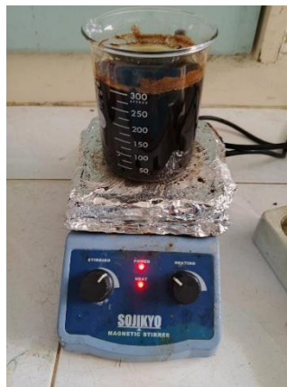
Gambar 3.9 Pencampuran HCl, Anilin, dan APS menggunakan HPMS
