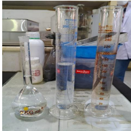
Gambar 3.8 Penyiapan HCl, APS dan Anilin untuk Polimerisasi
