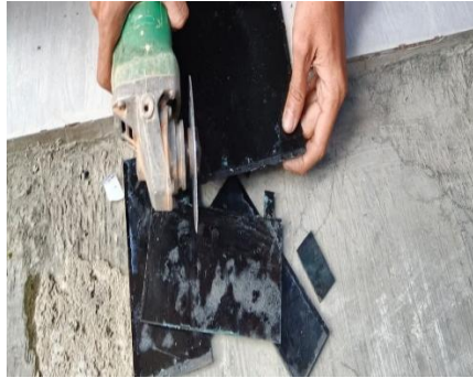
Gambar 3.20 Pemotongan Komposit sesuai Spesifikasi Pengujian
