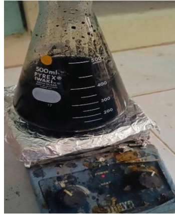
Gambar 3.12 Pencampuran MWCNT dengan \text{HNO}_3
