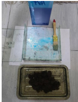
Gambar 3.19 Pencampuran Semua Komponen pada Cetakan Kaca
