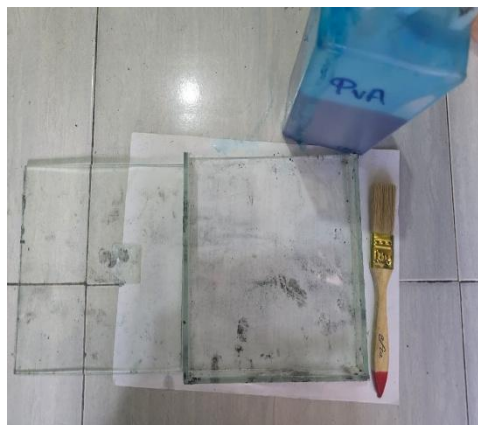
Gambar 3.17 Persiapan Pelapisan Kaca dengan Polyvinyl Alcohol
