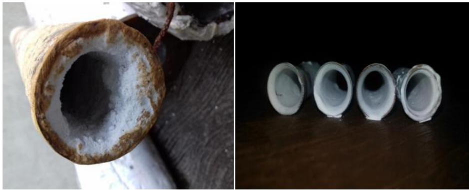
Gambar 2. Endapan kerak pada pipa (Vendamawan, 2016).
