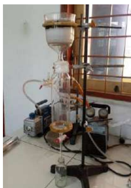
Gambar 8. Alat Kromatografi Cair Vakum (KCV)
