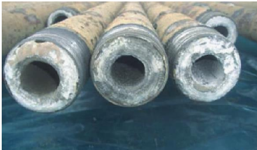
Gambar 1. Endapan kerak kalsium karbonat dalam pipa (Putranto et al. , 2020).
