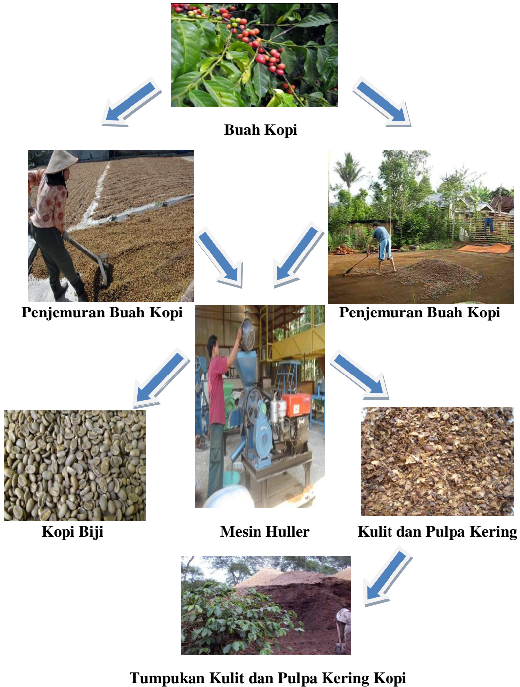
Gambar 2. Diagram Alir Pemisahan Biji Kopi dan Kulit Kopi dengan Mesin Huller
