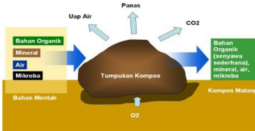
Gambar 3. Proses umum pengomposan limbah padat organik (Rynk, 1992, dimodifikasi)
