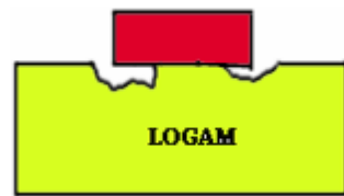
Gambar 2.3. Korosi celah ( crevice corrosion ) (sumber Priyotomo, 2008).
