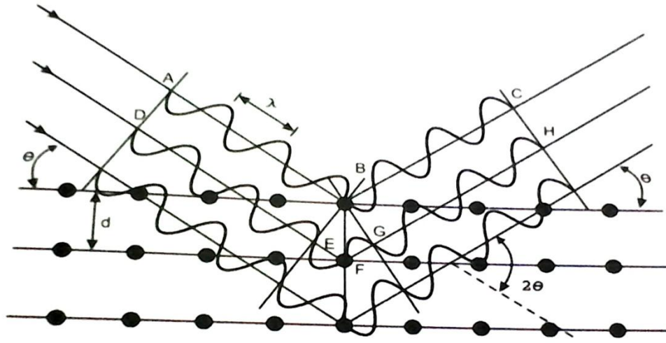
Gambar 2.13. Sinar-X yang dihamburkan oleh atom-atom kristal yang berjarak d (Richman, 1967).
