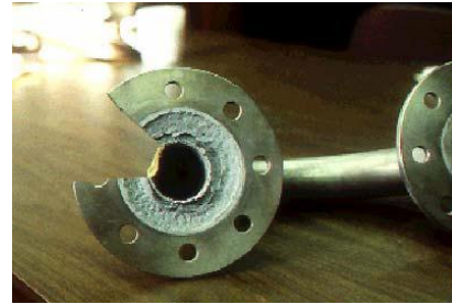
Gambar 2.3. Korosi celah ( crevice corrosion ) (sumber Priyotomo, 2008).
