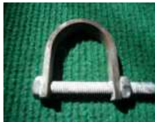
Gambar 9. U- bend dengan pembebanan statik baut M6 (Sumber :Lab. Metrologi Industri Unila, 2012)
