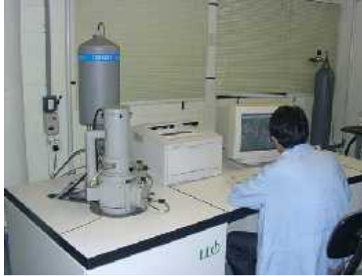
Gambar 18. Rangkaian alat uji SEM ( Sumber: Lab. Metalurgi UI Depok, 2012)
