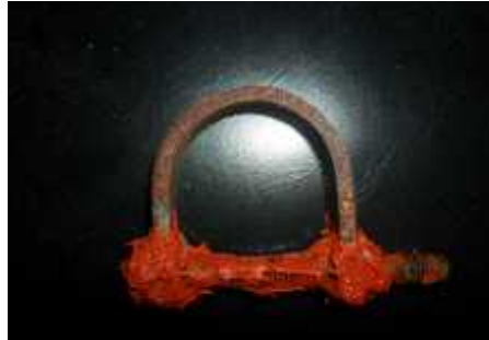
Gambar 10. U-bend dengan dilapisi sealant (Sumber :Lab Metrologi Industri Unila, 2012)
