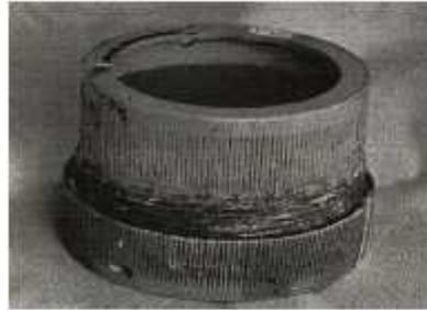
Gambar 15. Korosi galvanik pada ujung pipa pengisi bahan bakar pesawat yang terbuat dari paduan magnesium yang menjadi aus setelah dilumasi dengan lemak grafit (Trethewey, 1991).
