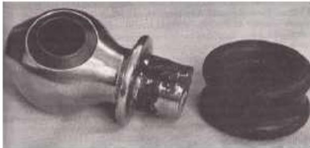
Gambar 13. Korosi celah pada sambungan universal baja nirkarat
