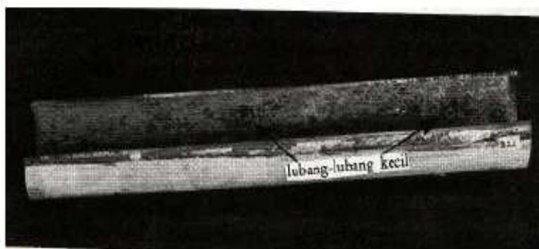
Gambar 14. Korosi sumuran yang terjadi pada dinding pipa air tembaga
