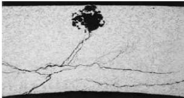
Gambar 17. Korosi retak tegang (Sumber: NASA, corrosion division)
