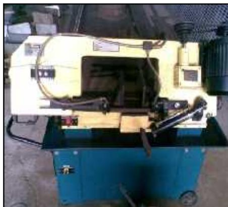
Gambar 23. Gergaji mekanik digunakan untuk memotong pelat baja
