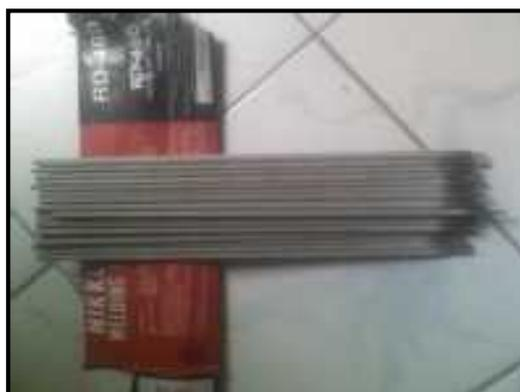
Gambar 19. Busur elektroda E 7018
