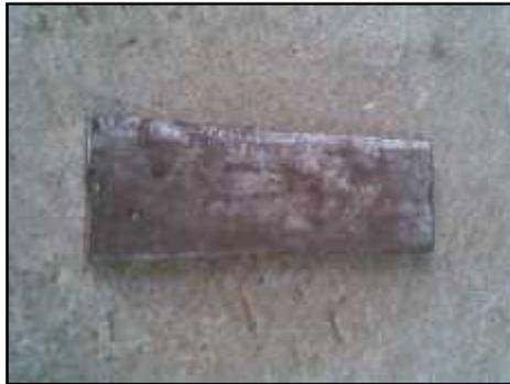
Gambar 18. Plat baja karbon AISI 1045
