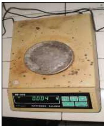
Gambar 29. Timbangan digital untuk menimbang berat benda uji
