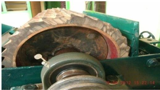
Gambar 11. Mekanisme pengupasan
