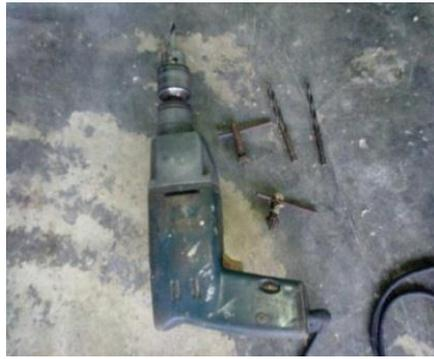
Gambar 7. Mesin bor tangan.
