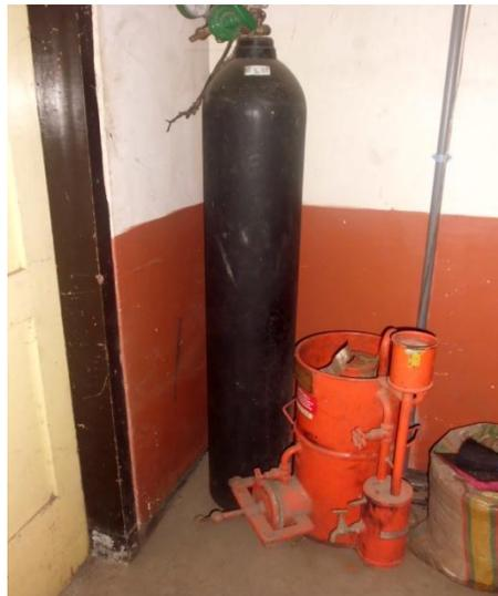
Gambar 11. Mesin Las Oksi Asitilin
