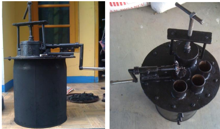
Gambar 12. Drum Kiln Pembakaran Sekam Padi
