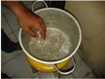
Pencampuran zeolit dengan air sumur Pencucian dan pengadukan zeolit dengan air sumur
