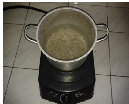
Perebusan zeolit selama 30 menit
