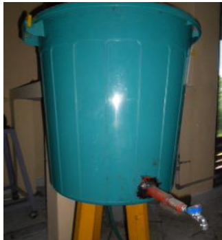
Perendaman air sumur dengan zeolit
