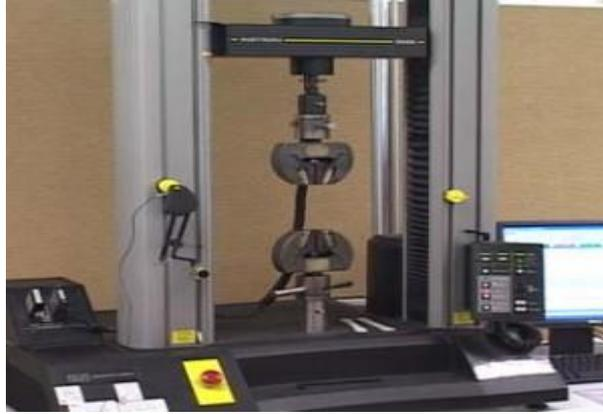
Gambar 3.3. Mesin Uji tarik
