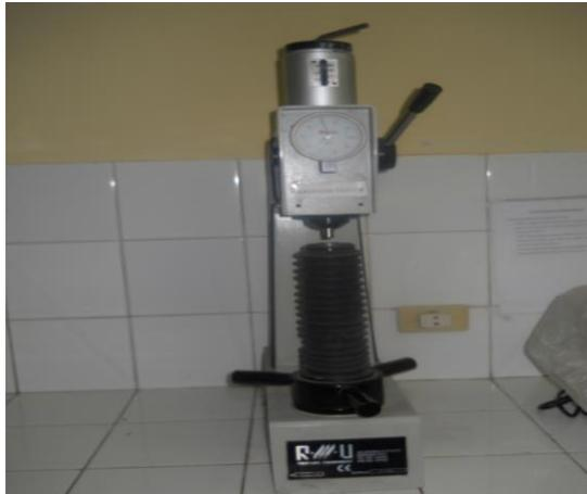
Gambar 3.4. Alat Uji Kekerasan Universal
