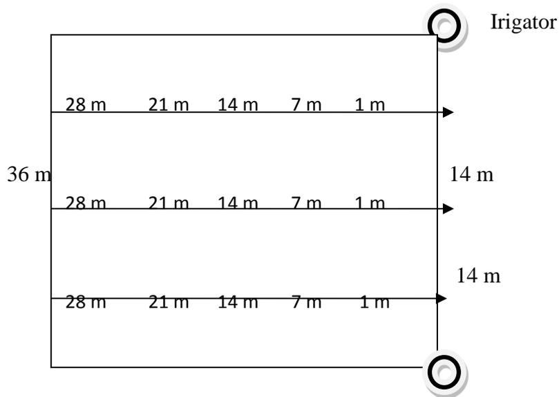
Gambar 1. Jarak semprot irigator dengan metode Grid
