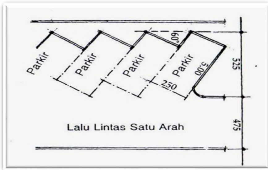
Gambar 9. Parkiran dengan sudut 60^{\circ}
