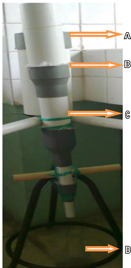
Gambar 3. Alat yang digunakan untuk mengekstrak daun mengkudu (A = bagian paralon yang berisi daun mengkudu yang telah dihaluskan, B = kain kasa, C = bagian paralon yang berisi arang aktif, D = hasil ekstraksi).
