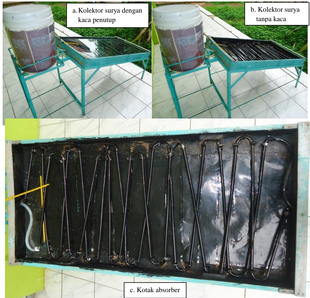
Gambar 14. Hasil rancang bangun alat pengumpul panas energi Matahari dengan sistem termosifon
