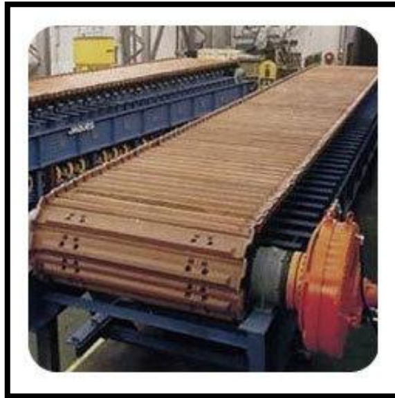
Gambar 6. Apron conveyor pada industri
