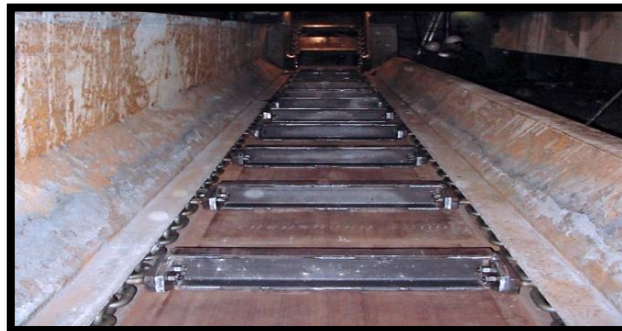
Gambar 5. Scraper conveyor pada industri
