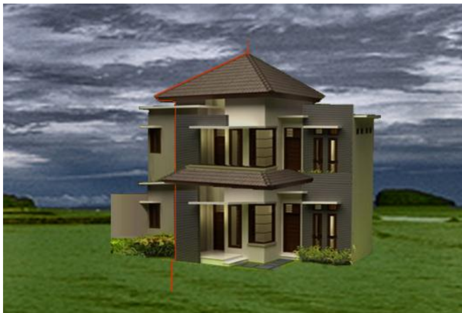
Gambar 2.1. Instalasi Penangkal Petir Sistem Franklin. [5]
