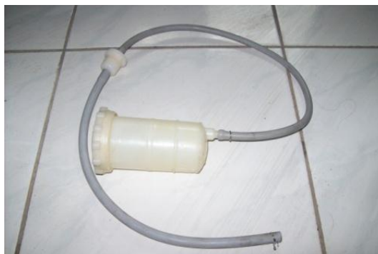
Gambar 12. Tangki bahan bakar buatan 350 ml dan selang bensin tambahan
