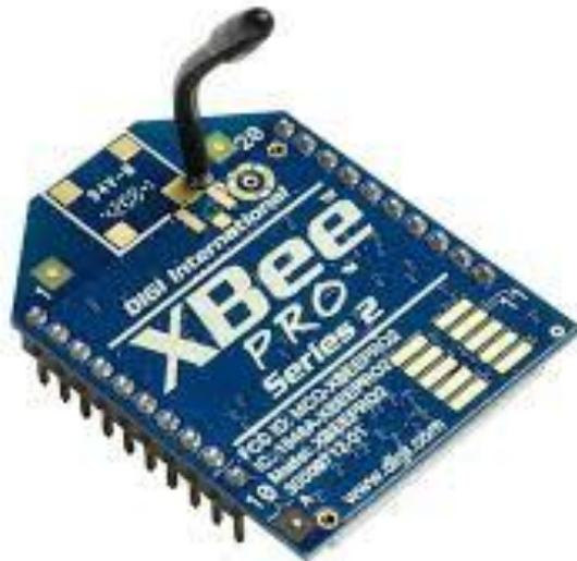
Gambar 8. Modul Xbee
