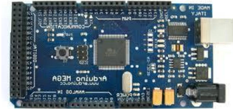
Gambar 1. Papan Mikrokontroler Arduino Mega
