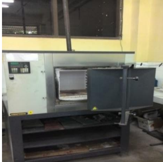
Gambar 3.4. Tungku Pemanas ( Furnace )
