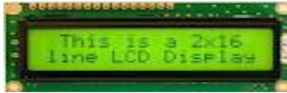
Gambar 2.3. Bentuk fisik modul karakter 2x16
