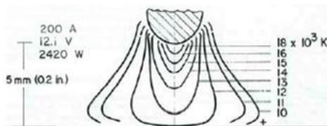
Gambar 2.10. Gambar isothermal busur listrik argon-tungsten (Kearns, 1981)
