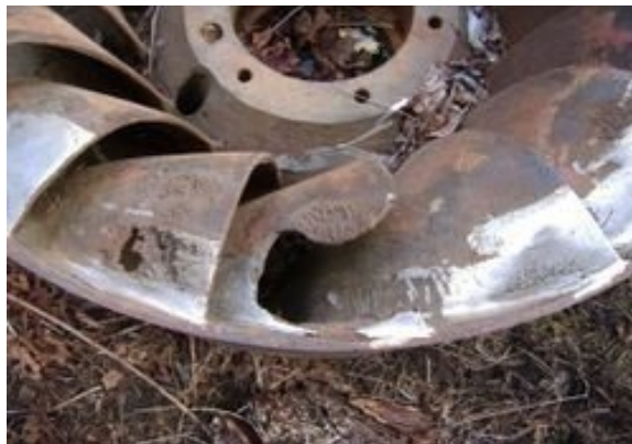
Gambar 16. Retakan Kelelahan Pada Turbin Francis
