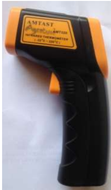
Gambar 6. Alat Pengukur Suhu Permukaan Daun.
