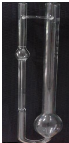
Gambar 8. Viskometer Ostwald (alat untuk mengukur viskositas)
