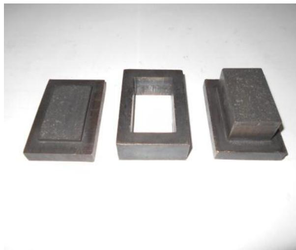
Gambar 31. Cetakan spesimen komposit
