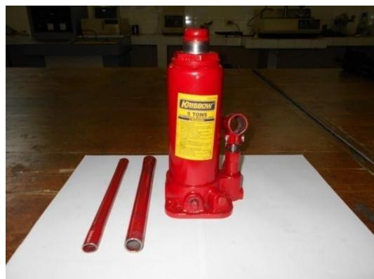
Gambar 29. Dongkrak hidrolik
