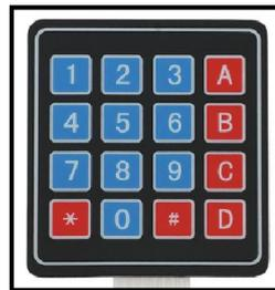
Gambar 2.20 Bentuk Fisik *Keypad* Matrik 4x4
