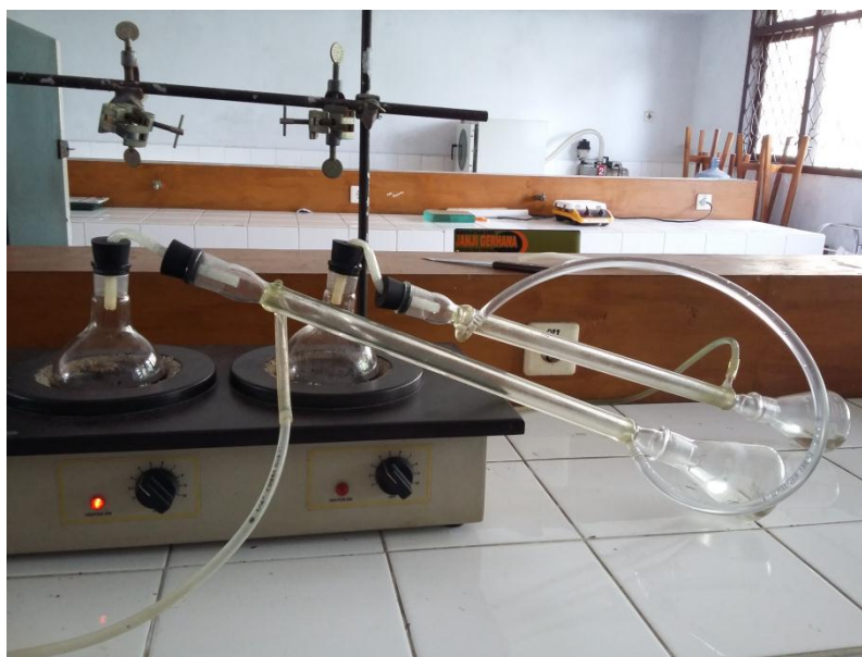
Gambar 3. Proses pemurnian asap cair sabut kelapa
