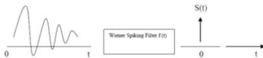
Gambar 3.11 Prinsip filter Wiener yang mengubah sinyal menjadi paku.
