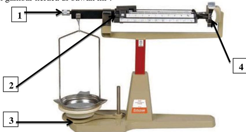
Bagian pada neraca di atas yang digunakan untuk mengkalibrasi (meng-nol-kan skala ketika tidak ada benda yg diukur) ditunjukkan oleh angka ...
