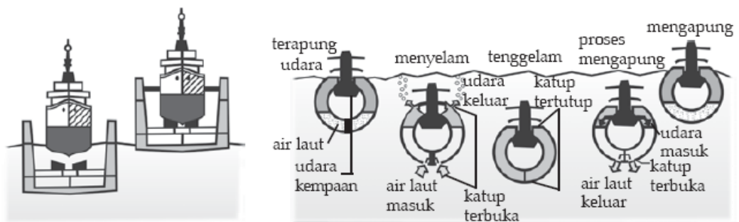
(a) Galangan Kapal (b) Prinsip mengapung dan tenggelam pada kapal selam
