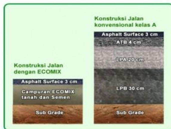
**Gambar 4.** Lapis Perkerasan Jalan
