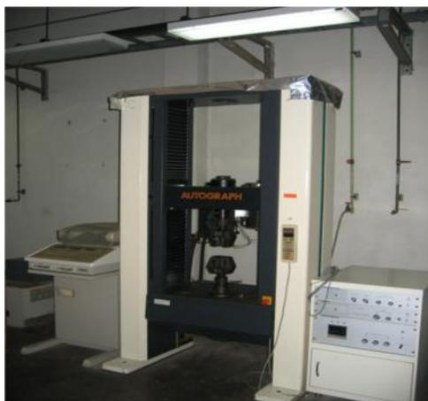
Gambar 3. Mesin Uji Tarik (*Universal Testing Machine*) (Dowling, 1999). Titik *Yield Point* sukar ditentukan dengan tepat karena itu biasanya ditentukan batas *Elastic* dengan perpanjangan tetap sebesar 0,005% sampai 0,01%.
