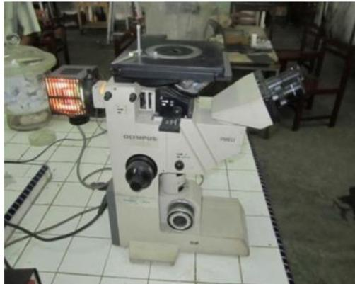
Gambar10. Alat Uji Foto Mikro (*Mikroskop optik*)
