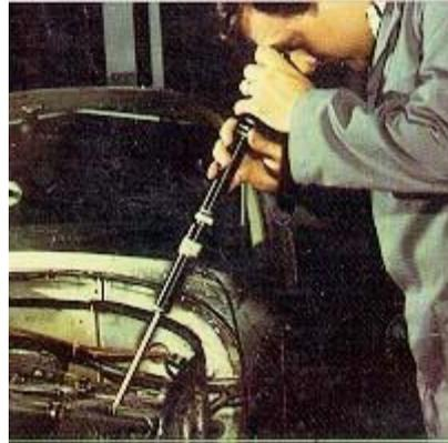
Gambar 13. *Visual inspection* dengan boroskop
