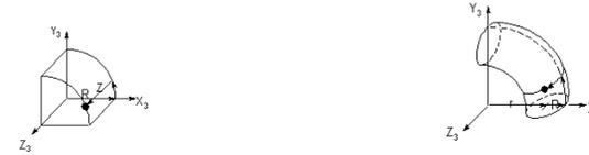
**Gambar 29.** Koordinat silindris ( $R, \theta, Z$ )      **Gambar 30.** Koordinat toroidal ( $R, \theta, \phi$ ) dengan parameter  $r$
