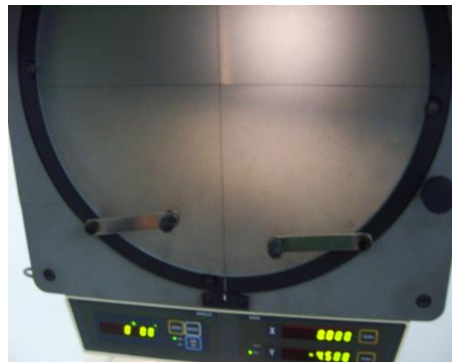
Gambar 43. Data Keausan tepi vb 2 menit dengan sudut geram pahat negatif 6^\circ , feeding 0,245 mm/langkah, kecepatan potong 11,8 m/min.
