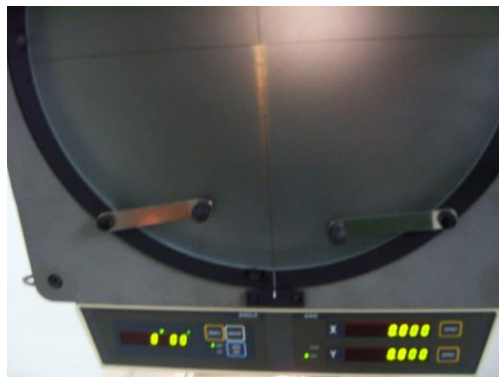
Gambar 48. Data Keausan tepi vb 2 menit dengan sudut geram pahat 0^\circ , feeding 0,115 mm/langkah, kecepatan potong 25,1 m/min.
