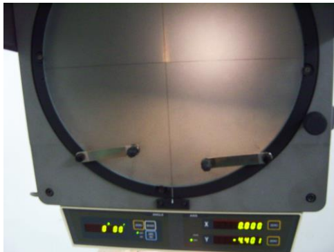
Gambar 50. Data Keausan tepi vb 2 menit dengan sudut geram pahat 0^\circ , feeding 0,245 mm/langkah, kecepatan potong 19,2 m/min.
