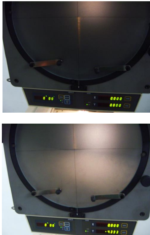
Gambar 45. Data Keausan tepi vb 2 menit dengan sudut geram pahat negatif 6^\circ , feeding 0,245 mm/langkah, kecepatan potong 25,1 m/min.
