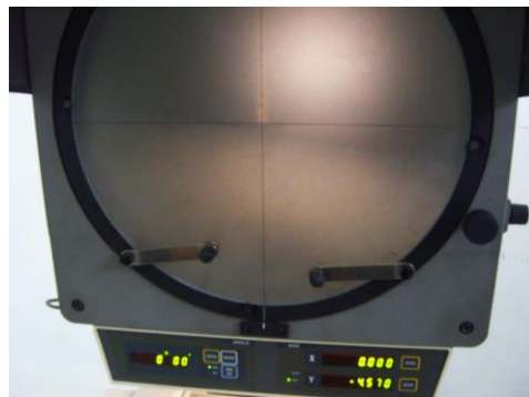
Gambar 46. Data Keausan tepi vb 2 menit dengan sudut geram pahat 0^\circ , feeding 0,115 mm/langkah, kecepatan potong 11,8 m/min.
