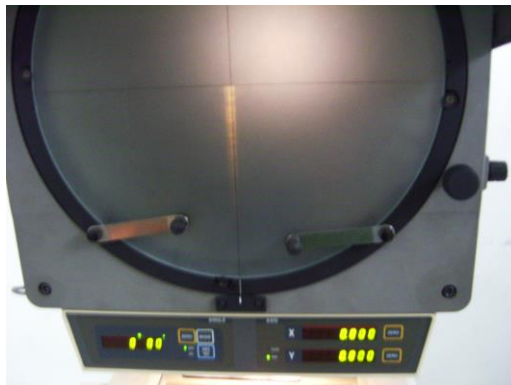
Gambar 50. Data Keausan tepi vb 2 menit dengan sudut geram pahat 0^\circ , feeding 0,245 mm/langkah, kecepatan potong 19,2 m/min.
