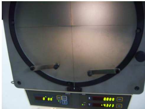
Gambar 48. Data Keausan tepi vb 2 menit dengan sudut geram pahat 0^\circ , feeding 0,115 mm/langkah, kecepatan potong 25,1 m/min.
