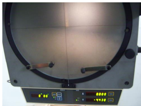
Gambar 47. Data Keausan tepi vb 2 menit dengan sudut geram pahat 0^\circ , feeding 0,115 mm/langkah, kecepatan potong 19,2 m/min.
