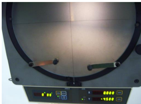
Gambar 41. Data Keausan tepi vb 2 menit dengan sudut geram pahat negatif 6 °, feeding 0,115 mm/langkah, kecepatan potong 19,2 m/min.
