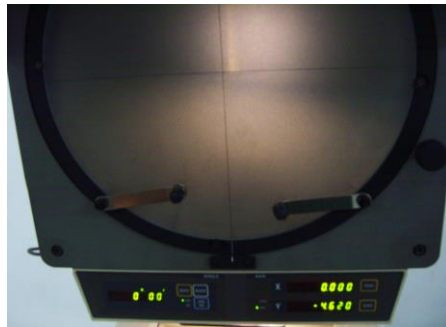
Gambar 40. Data Keausan tepi vb 2 menit dengan sudut geram pahat negatif 6 °, feeding 0,115 mm/langkah, kecepatan potong 11,8 m/min.
