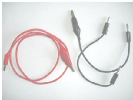
Gambar 4. Kabel penghantar arus DC
