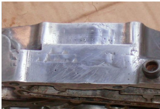
Gambar 15. Crank case yang telah dirubah (keterangan gambar di lampiran)
