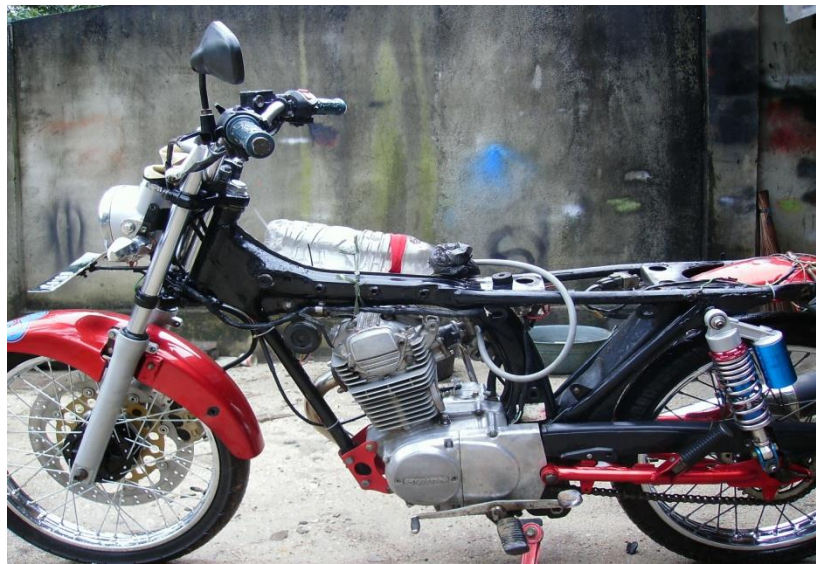
Gambar 18. Honda CB modifikasi yang menggunakan botol aqua pada pengujian bahan bakar.
