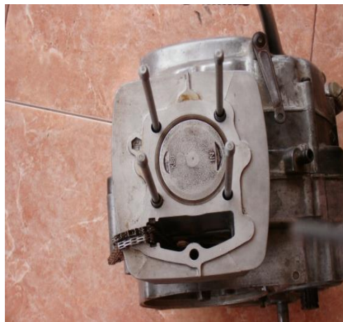
Gambar 16. Pemasangan blok silinder (keterangan gambar di lampiran)
