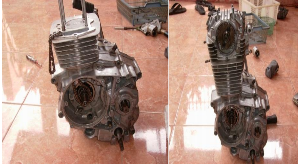
Gambar 17. pemasangan gigi sentrik (keterangan gambar di lampiran)
