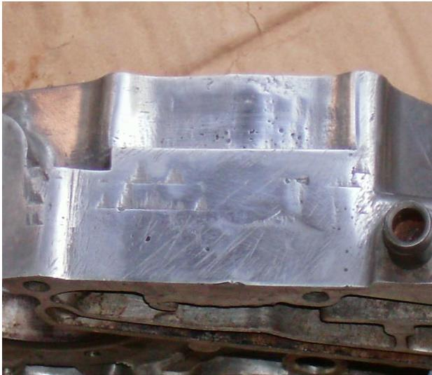
Gambar 22. Crank Case yang di las
