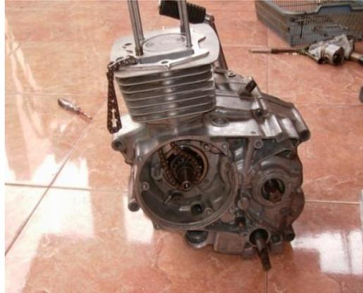
Gambar 25. Pemasangan blok silinder ke dalam *crank case*
