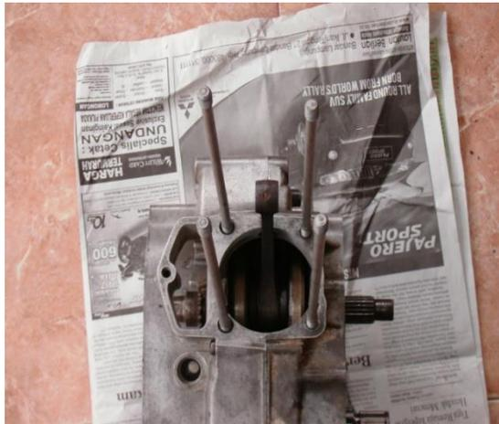
Gambar 24. Pemasangan baut *crank case*
