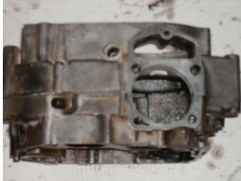
Gambar 20. Crank Case CB yang telah dibubut
