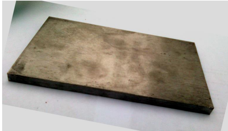
Gambar 17. Benda Kerja AISI 1045
